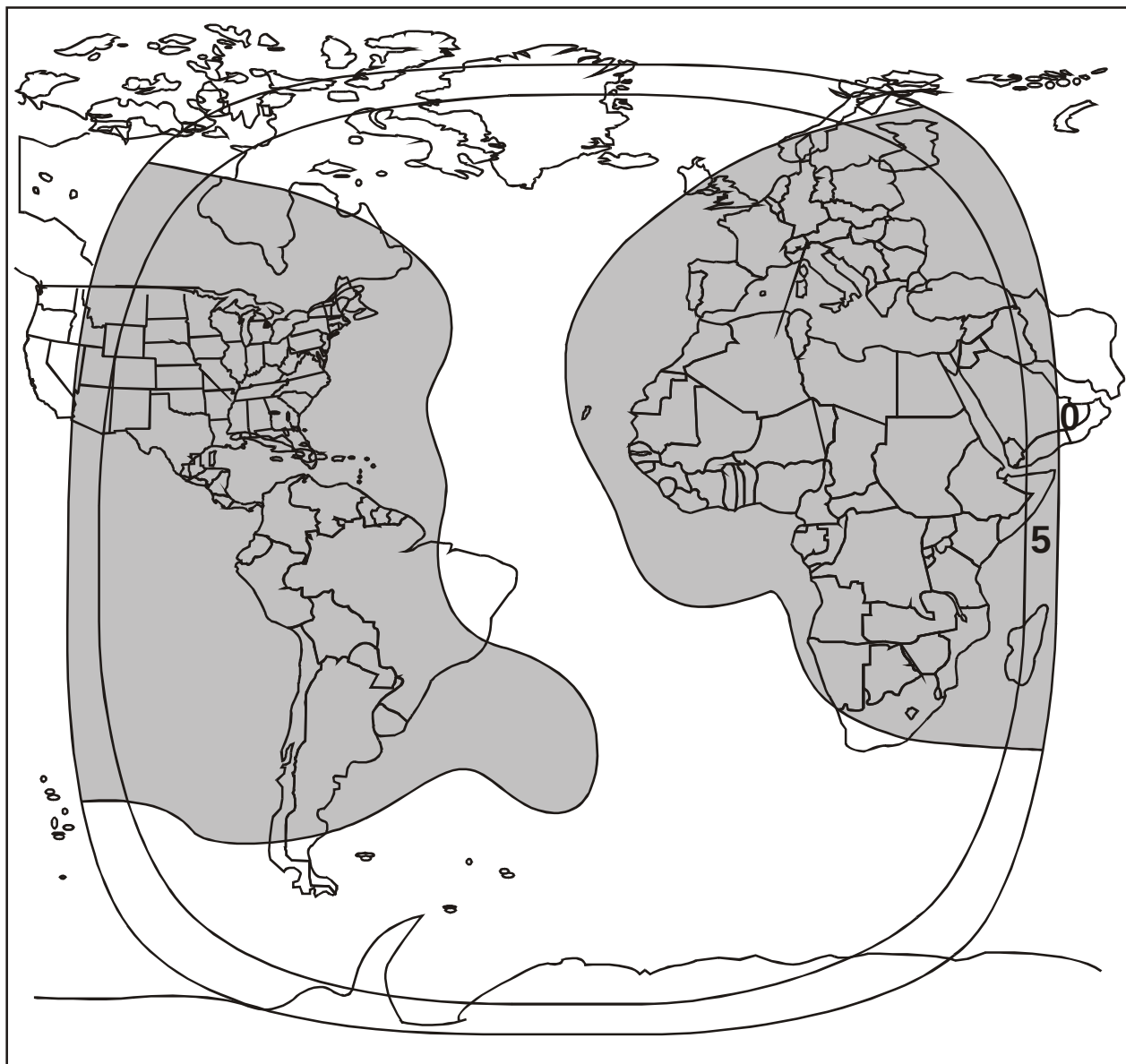
Рис. A1-1. Зона охвата системы 1 международной спутниковой телесвязи (ISCS1), применяемой ВЦЗП в Вашингтоне. Для вещания используется спутник INTELSAT с координатами 34,5°з.д. (атлантический спутник).
